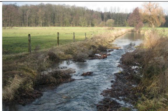
Abb. 8: Teil der Lösung von Haus Stapel bei Havixbeck; gut zu erkennen im Hintergrund ein Teil der Gräfte mit Mühlenstau, im Vordergrund die Sohlgleite unterhalb der neu eingerichteten Furt; die Münster'sche Aa konnte neben der Durchgängigkeit auch auf gut 200 m Länge wieder ein natürlicheres Fließregime bekommen
