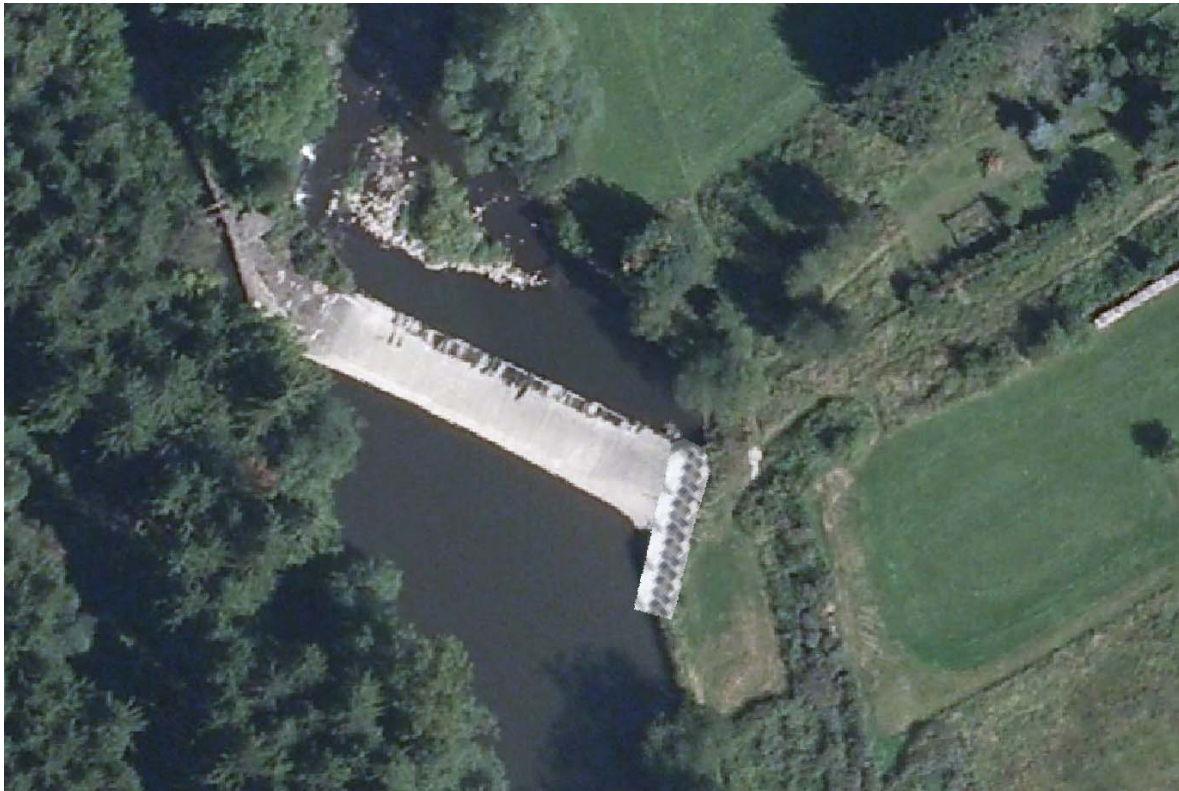
Abb. 78: Mäanderfischpass in einer Photomontage am Oberwehr
