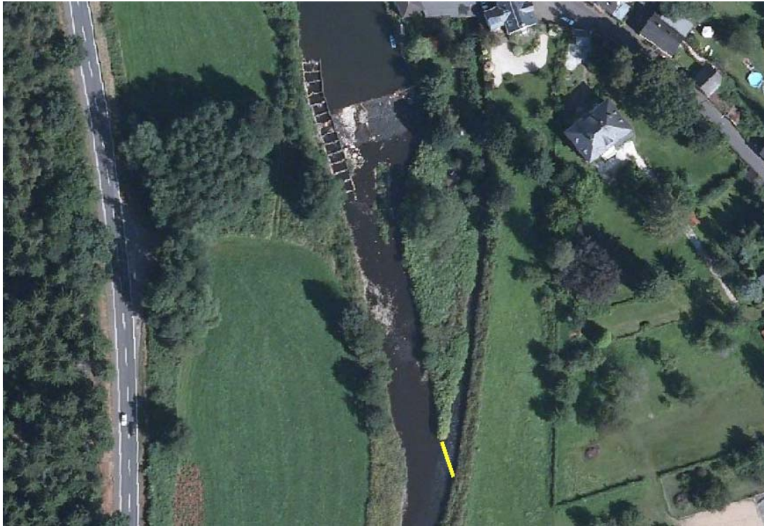
Abb. 52: Gelb markiert die fiktive Lage einer Sohlschwelle im Turbinenauslauf
