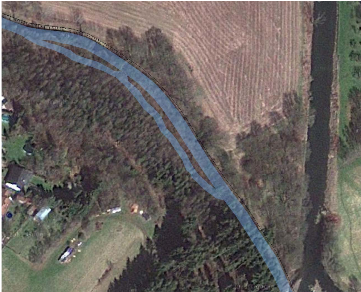
Abb. 73: Der Ortsteil Freusburgermühle, der Mühlgraben und die geplante Aufweitung des Mühlgrabens durch Anlage eines Nebengerinnes mit Versumpfung der umliegenden Flächen in der ungefähren, künftigen Lage; die genaue Lage wird im Zuge des Antragsverfahrens bestimmt und eingemessen
