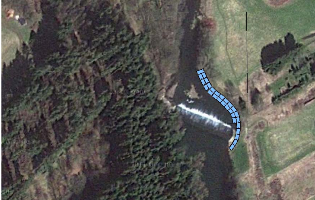
Abb. 77: Beckenpass in Anlehnung an das bestehende Ufermauerwerk mit Strömungsführung in einer Spitzkehre, damit der Einstieg am Fußpunkt der Wehrgleite liegt; das Ufermauerwerk wäre durch die Betonkonstruktion zu ersetzen;
